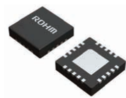
基于Exposed Pad的 高效散热特性
